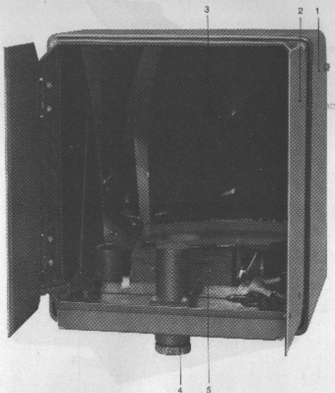
**Bild 4 Scheinwerfer mit geöffneten Klappen**
